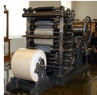
Rotative à bobine de type Marinoni (France, 1883).
